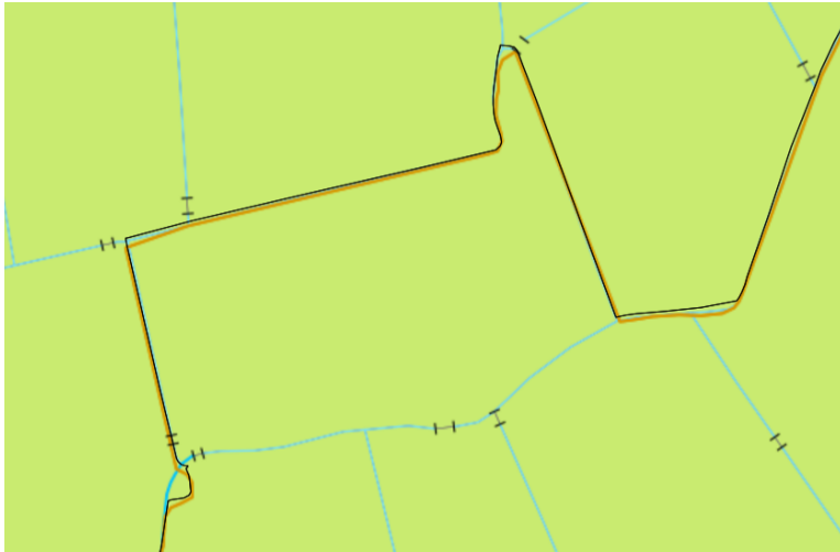
Figuur 9: Verschillen in grensligging tussen BRK en Top10NL (op basis van de BRT) als gevolg van generalisatie en schaalverschillen tussen de gemeenten Leeuwarden en Waadhoeke.
